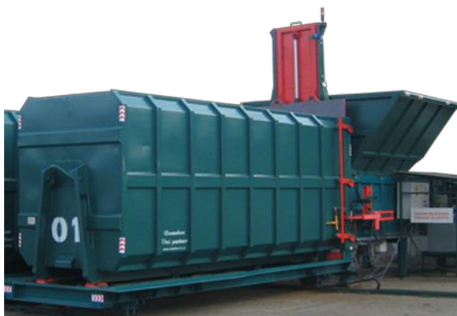
Сл. 5 Трансфер станица (хидраулична преса и контејнер)
