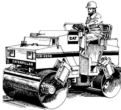
Сл.2 Забрањено је да радник иде испред контра моторног ваљка и премазује и кваси делове ваљка за равнање асфалтне масе
